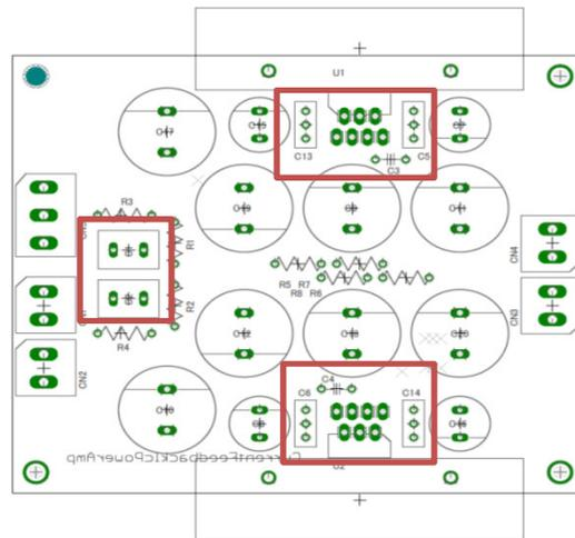
3. C7,C8,C15,C16基板へ取り付け、はんだ付けします。
