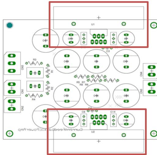
7. 基板の4隅の穴へM3のネジを入れ、スペーサーを固定すれば完成です。
