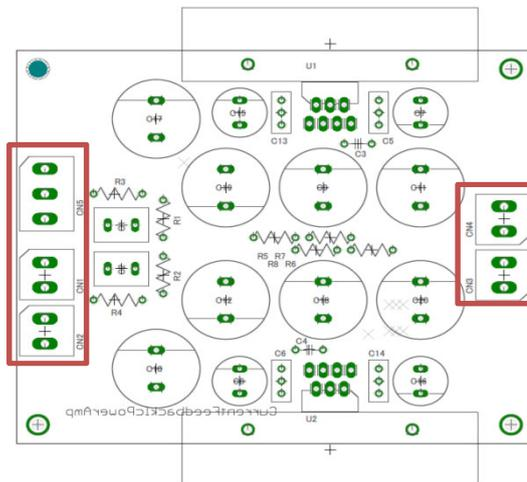
5. C9,C10,C11,C12,C17,C18,C19,C20を基板へ取り付け、はんだ付けします。
