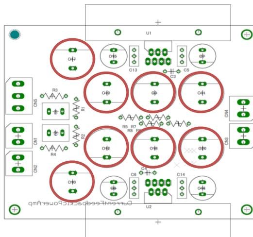
6. U1及びU2について、あらかじめヒートシンク(15PB054-01050)に絶縁シートを貼り付け、M3のプラネジによって固定します。電流帰還オペアンプとヒートシンクが一体となった状態で基板へリード部を差し込み、はんだ付けします。ヒートシンクも必要であれば任意の方法で固定して
