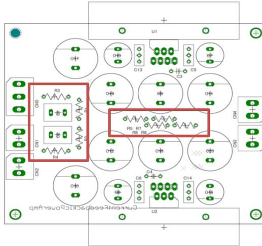
2. C1,C2,C3,C4,C5,C6,C13,C14を基板へ取り付け、はんだ付けします。
