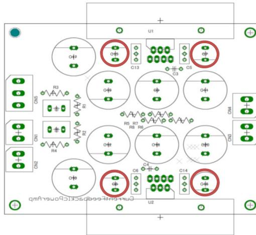
4. CN1,CN2,CN3,CN4,CN5を基板へ取り付け、はんだ付けします。
